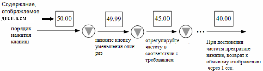
Рис. 4-8 Пример регулировки установленной частоты
