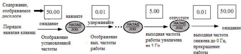
Рис. 4-9 Пример функционирования толчковой работы
